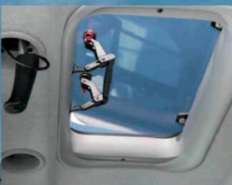
Новый тонированный люк на крыше улучшает циркуляцию воздуха, защищая при этом от сильной солнечной радиации.
